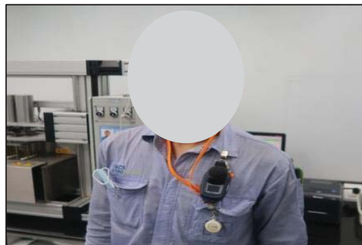
ภาพถ่ายที่ 3.4.2.9-1 การตรวจวัดระดับเสียงเฉลี่ย 12 ชั่วโมง ในพื้นที่ทำงาน และระดับเสียงสะสมตลอดเวลาการทำงาน ของพนักงาน โครงการผลิต ABS/SAN บริษัท อินนออส สไตโรลูชั่น (ประเทศไทย) จำกัด ระหว่างเดือนมกราคม-มิถุนายน 2567
