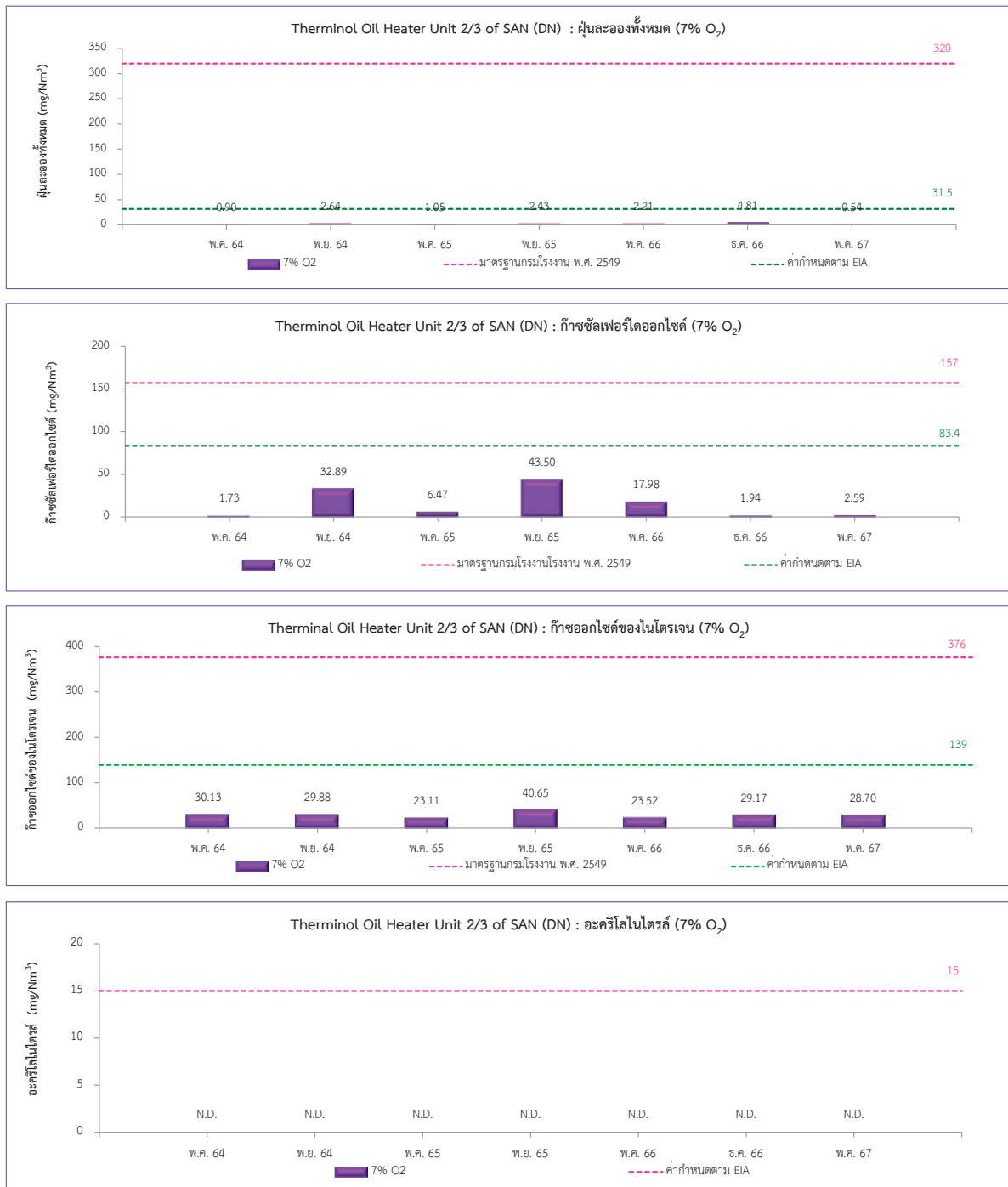
รูปที่ 3.4.2.1-5 เปรียบเทียบผลการตรวจวัดคุณภาพอากาศที่ระบายออกจากปล่อง Therminol Oil Heater ชุดที่ 2/3 ของหน่วยผลิต SAN (DN) ระหว่างปี พ.ศ. 2564-2567
